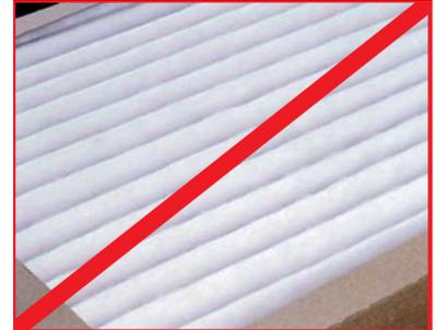
Große Faltenabstände und runde Außenkonturen: Die Luftströmung erreicht kaum den Faltengrund. Die Staubeinlagerung erfolgt oberflächlich, Standzeiten sind reduziert.
